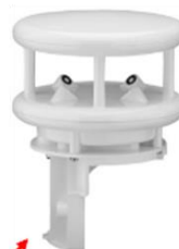
Anemómetro ultrassónico (a 10 e 40m do solo) Velocidade e direção do vento
