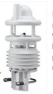
Estação meteorológica compacta (a 2,5m do solo) Velocidade do vento, temperatura, humidade, pressão atmosférica, precipitação, bússola/direção, radiação solar, detetor de descargas
