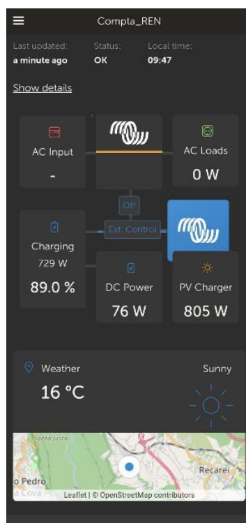
Imagem na App que mostra a produção solar e o nível das baterias
