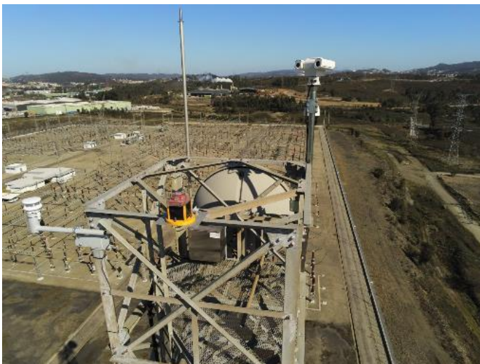
Foto dos sensores Anemómetros e suportes instalados a 10 m e a 48m na coluna montante da Torre
