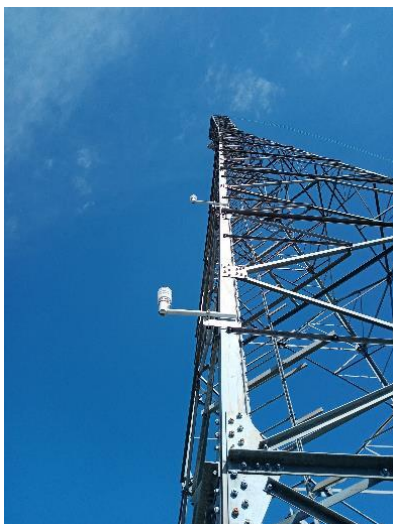
Foto dos sensores Anemómetros e suportes instalados a 10 m e a 48m na coluna montante da Torre
