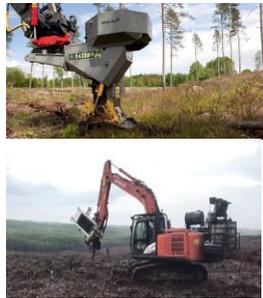
Sistema compreende dois buldózer. O primeiro rasga o solo o segundo planta.
