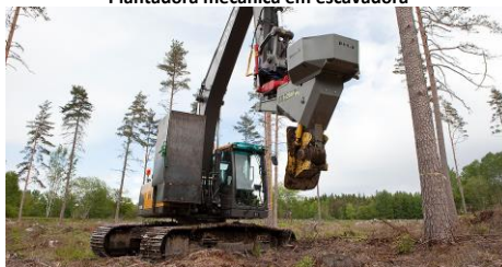
Plantadora mecânica em escavadora
